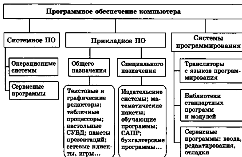
Рис. 7.1. Структура программного обеспечения компьютера
