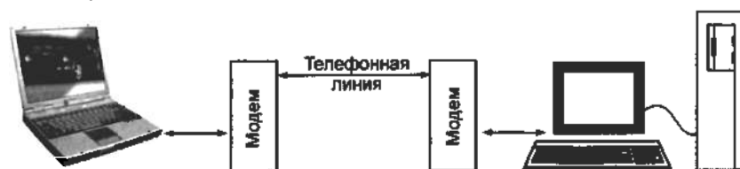
Рис. 1.2. Организация связи между пользователем и узлом сети по телефонной линии
