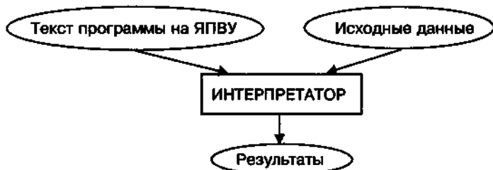
Рис. 6.20. Выполнение программы на ЯПВУ с использованием интерпретатора
