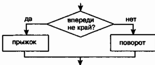
Рис. 5.12. Блок-схема полного ветвления
