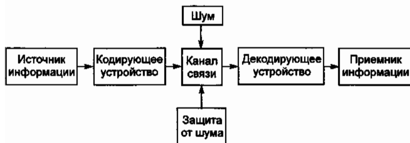
Рис. 1.3. Схема технической системы передачи информации
